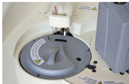
Particolare del sistema di lavaggio delle cuvette
