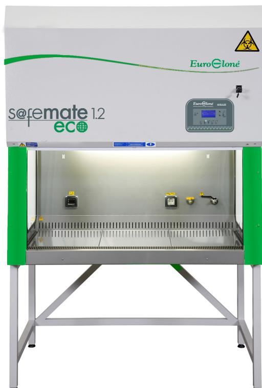
**S@femate** è una cabina di "Classe II", progettata e realizzata per consentire manipolazioni sterili, proteggendo l'operatore e l'ambiente circostante dai rischi di contaminazione biologica aerotrasportata. Le Cabine modello **S@femate ECO** hanno conseguito la certificazione EN12469:2000 presso il TUV Nord (Germania).
