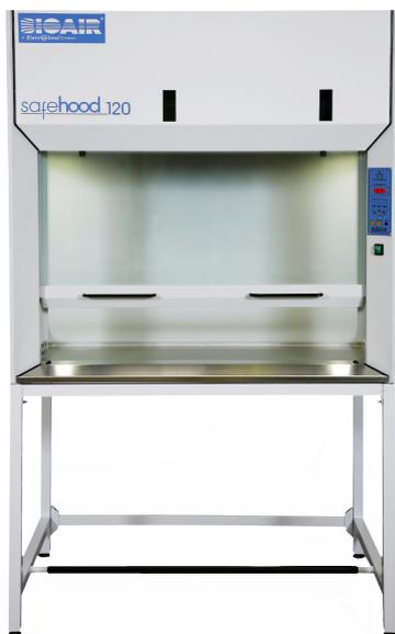
La linea di cappe chimiche a ricircolo SAFEHOOD utilizza filtri a carbone attivo per la rimozione di vari tipi di fumi, vapori o gas tossici dall'aria prima di reimmetterla in ambiente. Non sono richieste particolari condizioni o infrastrutture per l'installazione, rendendo le SafeHood il modo più semplice e rapido per garantire la sicurezza degli operatori durante l'uso di sostanze chimiche tossiche.
